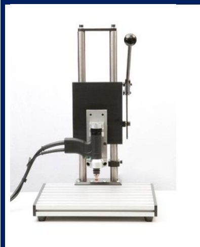
Stiftlasmachine met aluminium met een laagje oxide tafelblad.
