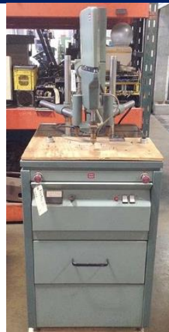
Stiftlasmachine met houten tafelblad.
